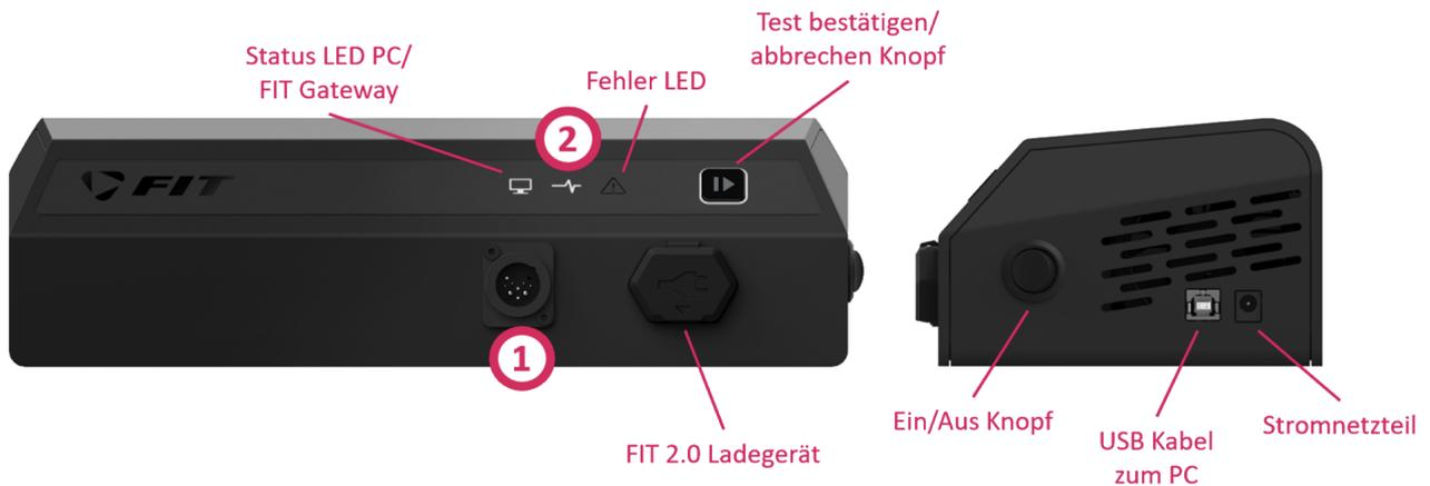
1. Den zu testenden Akku mit dem entsprechenden Entladekabel am FIT Akkutester anschliessen.
